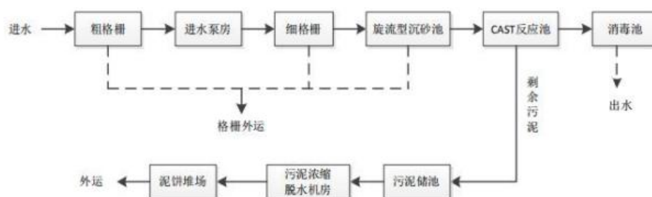
图 4-2 高新区污水处理厂污水处理工艺流程图
